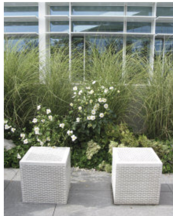
Particolare delle sedute luminose in cemento trasparente "I.light"; sullo sfondo una cortina leggera di Miscanthus "Morning light".
